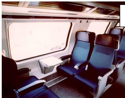
Seitenwandverkleidungen und Fensterrahmen...
